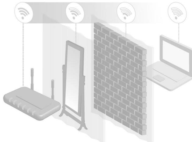
Buscar que el módem esté mínimo a 4m de otros aparatos eléctricos como teléfonos inalámbricos, hornos microondas, sistemas de seguridad inalámbricos, incluso si no los está utilizando.
